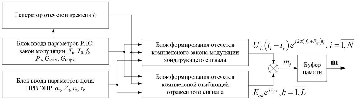
Рис. 1. Структурная схема имитатора отраженного сигнала
