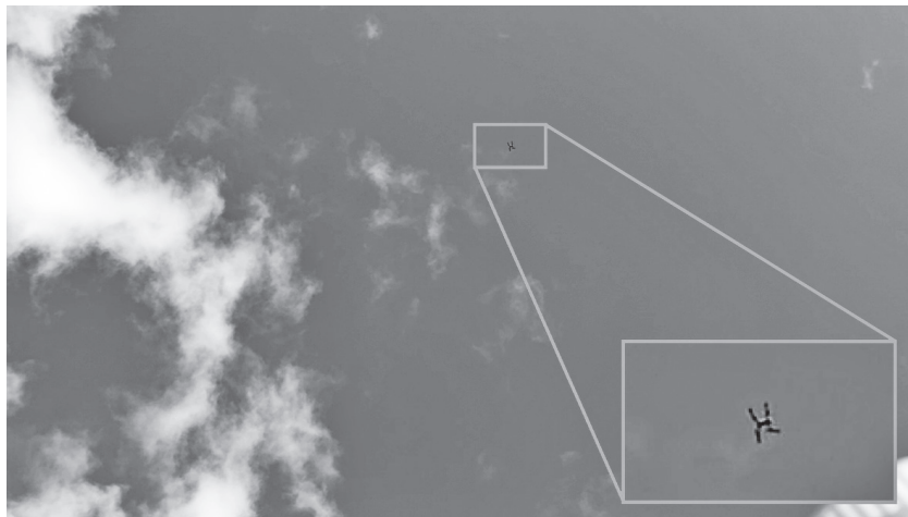
Рис. 4. Один из кадров датасета. Малым прямоугольником выделен реальный коптер, в большом для наглядности приведено его увеличенное изображение
