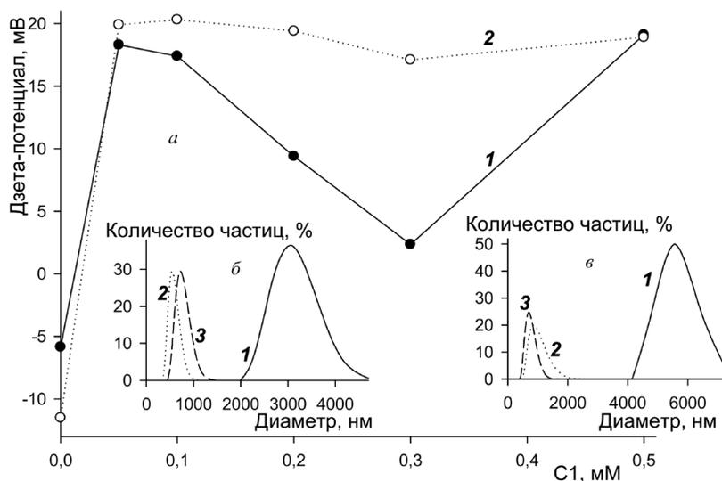
Рис. 2. Зависимость величины дзета-потенциала ассоциата ( $\text{Fe}_3\text{O}_4$ )C1 от концентрации С1 в среде его получения (а) (золи в водном растворе 0,1 мг/мл ПВП разведены в 40 (1) и 100 (2) раз); распределение количества частиц в зависимости от их гидродинамического диаметра для магнетита (б) и ассоциата ( $\text{Fe}_3\text{O}_4$ )C1 (в), полученного в среде с 0,05 мМ С1 (концентрированный золь (1), разведенный в 40 (2) и 100 (3) раз)
