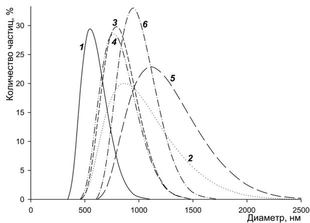
Рис. 3. Распределение количества частиц в зависимости от их гидродинамического диаметра магнетита (1) и ассоциата ( $\text{Fe}_3\text{O}_4$ )C1 (2–6): золи получены в среде, содержащей 0 (1), 0,05 (2), 0,1 (3), 0,2 (4), 0,3 (5) и 0,5 (6) мМ С1 и разведены дистиллированной водой в 40 раз
