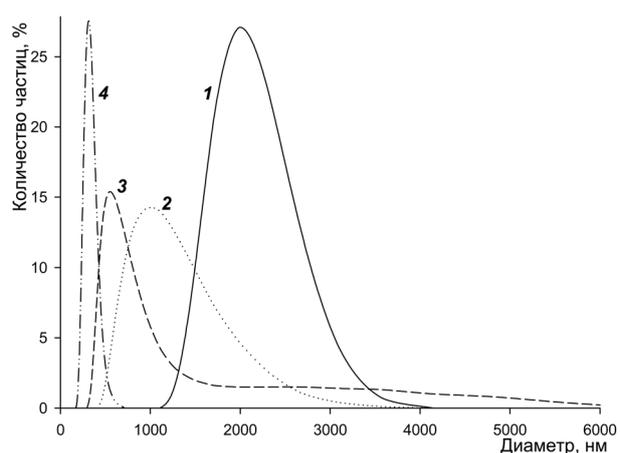
Рис. 5. Распределение количества частиц в зависимости от их гидродинамического диаметра магнетита (1, 2) и ассоциата  $(\text{Fe}_3\text{O}_4)\text{C}2$  (3, 4): 1 и 3 – исходный золь, 2 и 4 – разведенный дистиллированной водой в 40 раз
