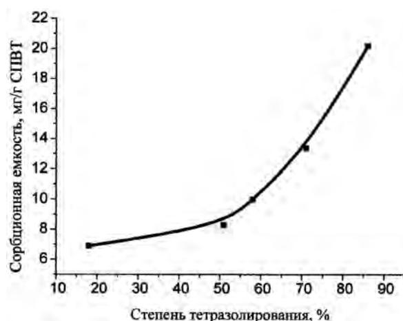
Рис. 1. Зависимость сорбционной емкости СПВТ по отношению к  $\text{Cu}^{2+}$  от степени тетразолирования (пленка толщиной  $55 \pm 10$  % мкм; время сорбции 3 ч)
