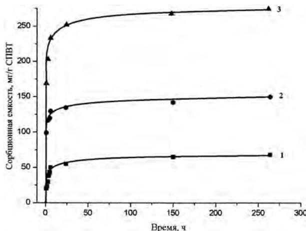
Рис. 2. Зависимость сорбционной емкости СПВТ в отношении  $\text{Cu}^{2+}$  от времени: 1 – пленка толщиной  $55 \pm 10$  мкм, 2 – порошок дисперсностью 40–60 мкм, 3 – пленка толщиной  $25 \pm 10$  мкм (СТ = 86 %)
