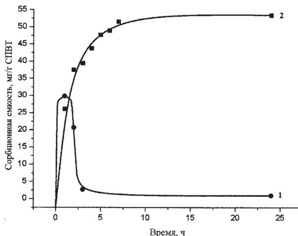
Рис. 4. Зависимость сорбционной емкости СПВТ от времени при совместной сорбции  $\text{Co}^{2+}$  (1) и  $\text{Cu}^{2+}$  (2) (пленка толщиной  $55 \pm 10$  мкм, СТ = 86 %)
