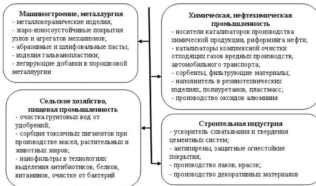
Рис. 3. Области применения гидроксидов алюминия
