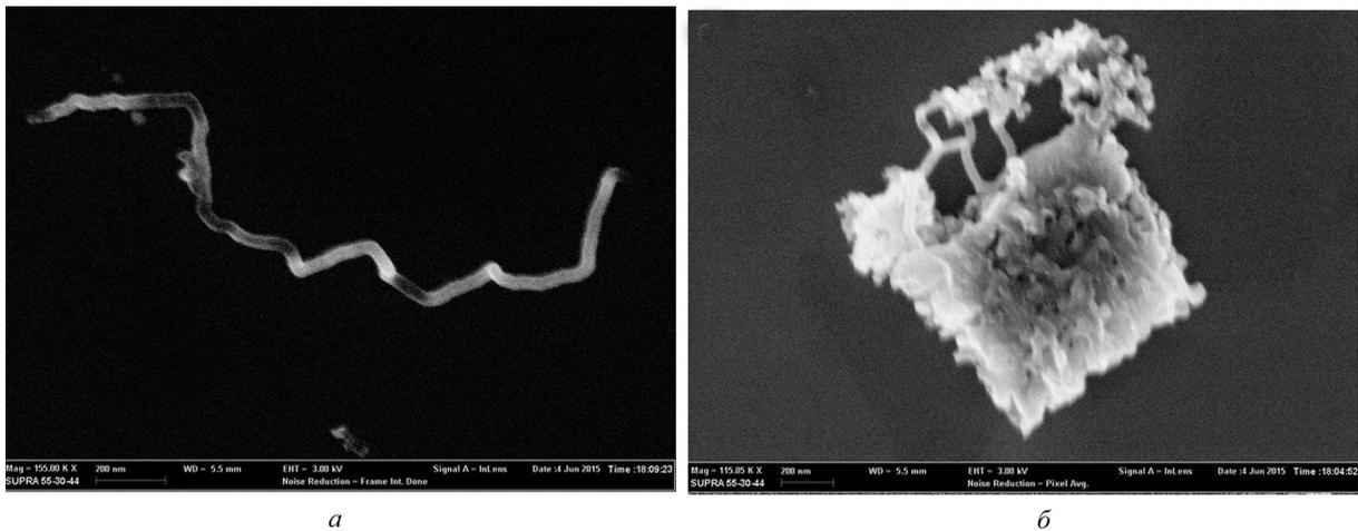
Рис. 2. СЭМ изображения композиционного монослоя ТК–УНТ, полученного из суспензии с массовым соотношением компонентов 1,0 : 1,0: *а* – УНТ, *б* – агломерат УНТ
