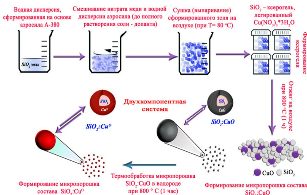
Рис. 1. Основные этапы получения микропорошков составов  $\text{SiO}_2 : \text{CuO}$  и  $\text{SiO}_2 : \text{Cu}^0$
