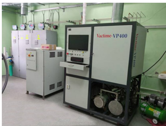
Рис. 1. Внешний вид экспериментальной установки CVD синтеза обогащенного бором пиролитического углерода (НИИ ЯП БГУ)
