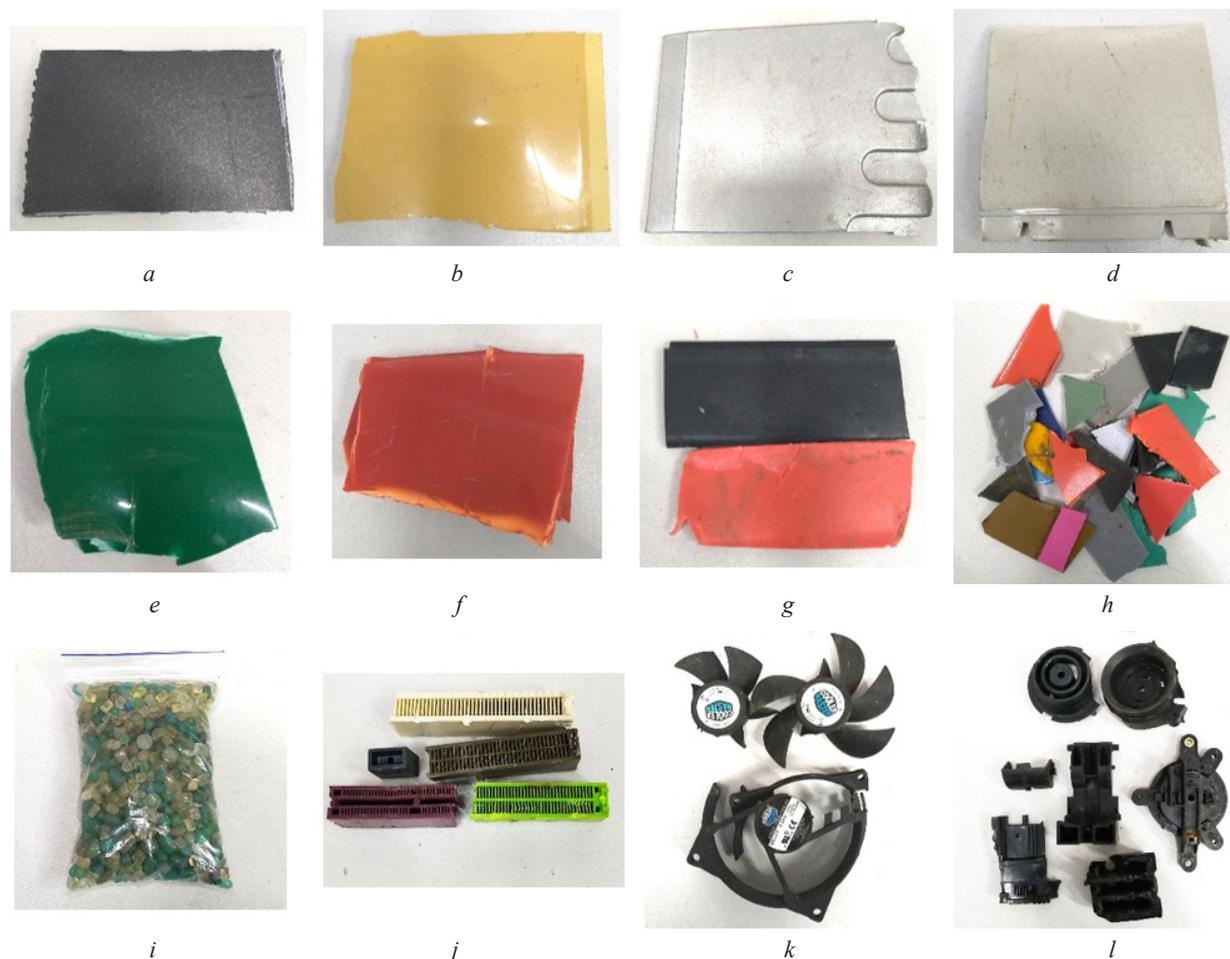
Рис. 1. Примеры проб пластмасс различных типов ЭЭО: *a–c* – телевизор с электронно-лучевой трубкой (ЭЛТ), *d* – монитор с ЭЛТ, *e, f* – пылесос, *g* – кухонный комбайн, *h* – смешанная проба измельченных пластмасс, *i* – смешанная проба разноцветных пластмассовых гранул, *j* – внутренние детали персонального компьютера (ПК), *k* – кулер ноутбука, *l* – внутренние детали электрочайника
