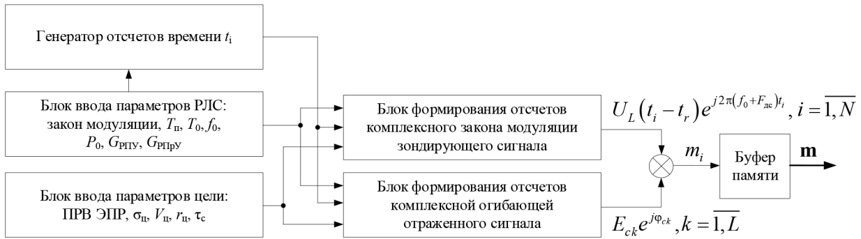
Рис. 1. Структурная схема имитатора отраженного сигнала
