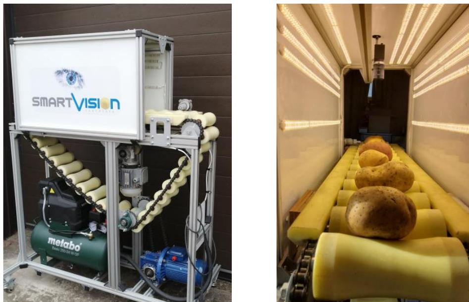
Рис. 1. Макетный образец автоматической сортировальной машины
